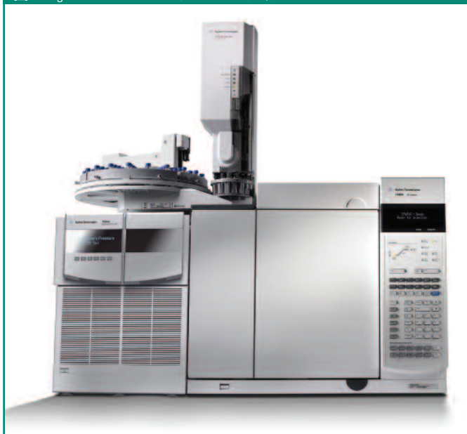
図 1. Agilent 7890A/7000A トリプル四重極 GC/MS システム
